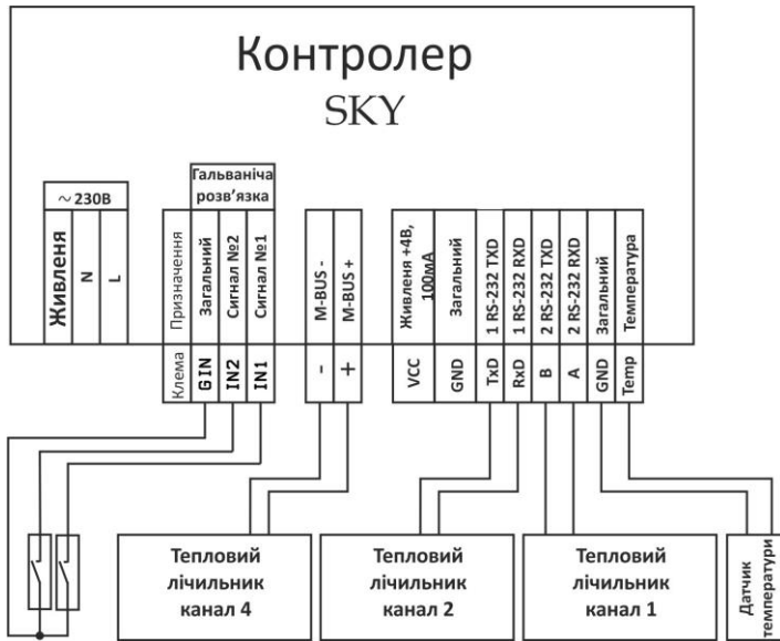
Рисунок 5. Схема зовнішніх з'єднань для лічильника тепла
